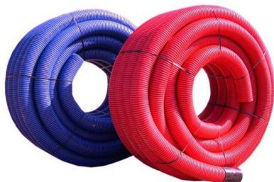
Doppelwandfalrohr aus HDPE/PE, rot/schwarz, für Stromkabel für Mittel- und Niederspannung und Telefonkabel, Außendurchmesser 63 mm, Innendurchmesser 50 mm, Zerdrückfestigkeit 450 N mit Verformung des Innendurchmessers gleich 5% gemäß CEI EN 50086-2-4/A1 (CEI 23-46;V1), IMQ-Siegel – CE-Siegel
